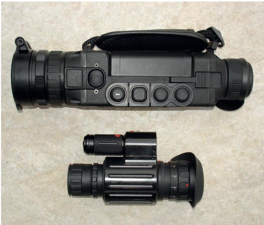
Oben Wärmebildgerät, unten Nachtsichtgerät
